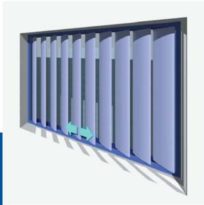
In der Regel ist eine Rotation zwischen 90° und 120° (Grad) erforderlich. Da diese Anwendung die Montage des Antriebs im Freien vorsieht, sollte ein geeigneter Schutz des Antriebs gegen die Sonneneinstrahlung und Regen bereitgestellt werden. Vorzugsweise sollten Antriebe mit hohen Schutzgraden (IP55) eingesetzt werden, um eine lange Lebensdauer zu gewährleisten.
